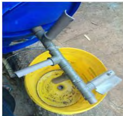
FIGURA 2 - Misturador utilizado para confecção da tinta de terra. Fonte: Arquivo dos autores (2015).
