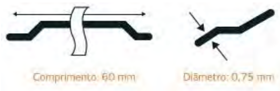
FIGURA 2 – Geometria fibra de aço RC 90/60 BN. Fonte: Dramix (2009).
