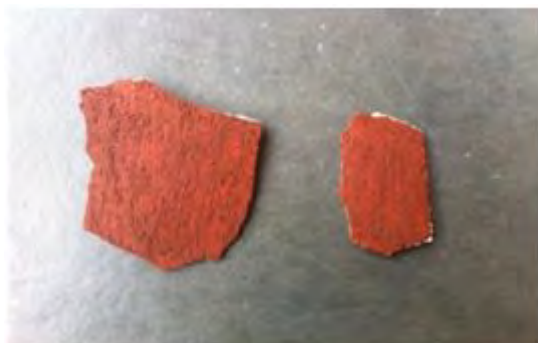
FIGURA 6 - Segunda demão de tinta em pedaços de gesso. Fonte: Arquivo dos autores (2015).
