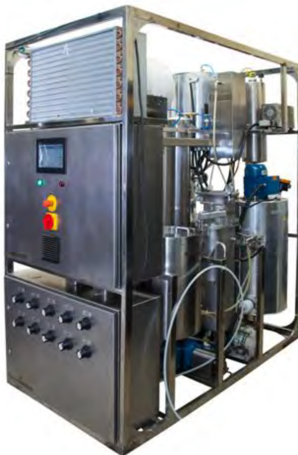
FIGURA 2: Usina Modular de Biodiesel (FIAT) durante testes de “Try-out”.
