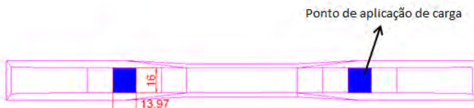
FIGURA 4 – Vista superior do dormente destacando a área de aplicação de força. Fonte: Próprio autor (2016).
