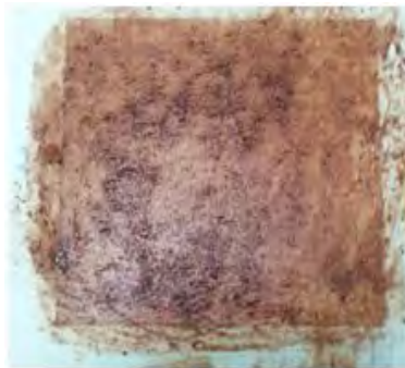
FIGURA 9 - Aplicação da tinta na placa de gesso. Fonte: Arquivo dos autores (2015).
