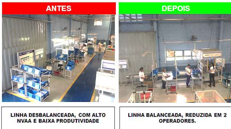
FIGURA 3 - Linha de montagem PM-003 antes e depois da realização do projeto. Fonte: Autoplas (2016).
