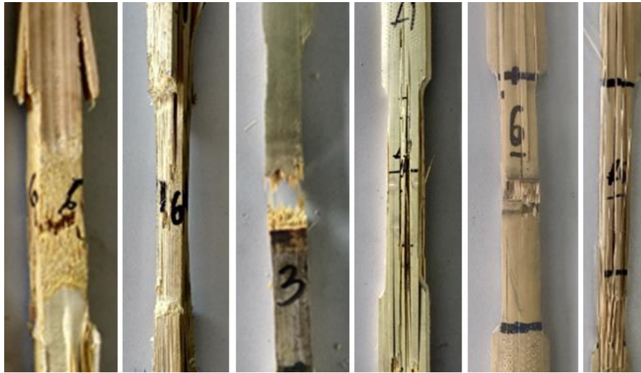
FIGURA 2 – Fraturas observadas nos corpos de prova fabricados de bambu gigante com e sem nó, mossô com e sem nó, e cana da Índia com e sem nó, da esquerda para direita.
