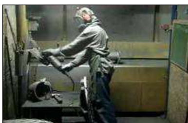
FIGURA 13 – Postura 13: operador desliga e posiciona a lixadeira no suporte no posto de trabalho na linha carrossel
