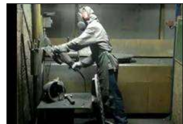
FIGURA 6 – Postura 6: operador pega e liga a lixadeira no posto de trabalho linha carrossel
