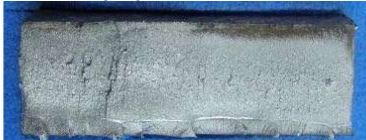
FIGURA 5 – Superfície de fratura de corpo de prova sem acabamento.
