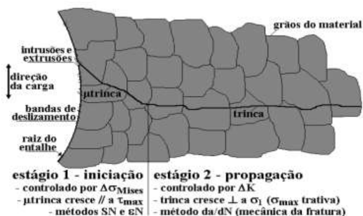
FIGURA 1 – Iniciação (estágio I) e propagação (estágio II) da trinca
