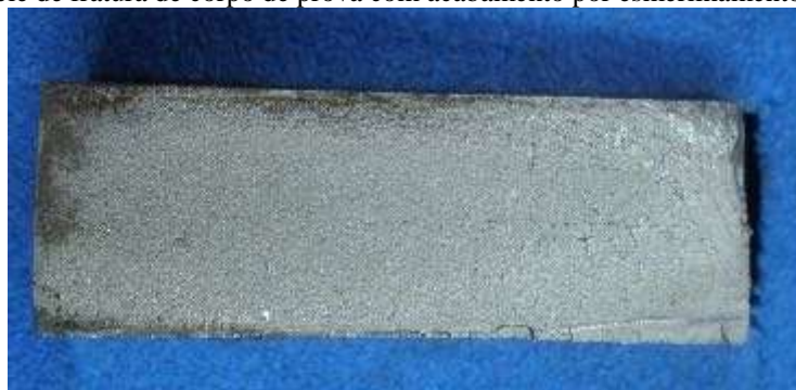
FIGURA 4 – Superfície de fratura de corpo de prova com acabamento por esmerilhamento.
