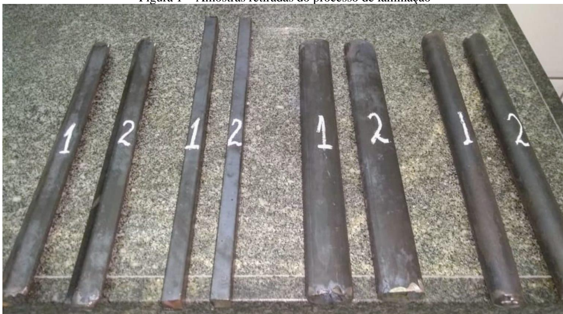
Figura 1 – Amostras retiradas do processo de laminação
