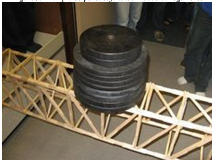
Figura 5: Exemplo de ponte sujeita a um dado carregamento
