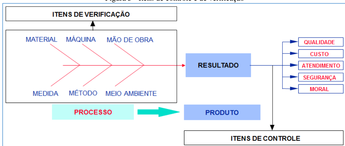
Figura 5 - Itens de controle e de verificação
