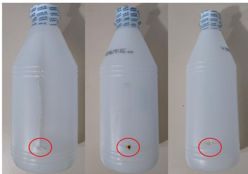
Figura 10 - Furo na parte lateral do frasco
