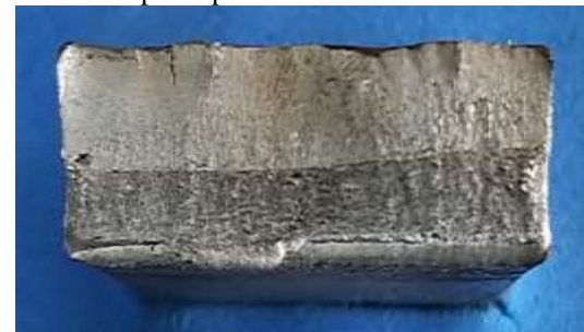
Figura 12 – Superfície de fratura do corpo de prova 3
