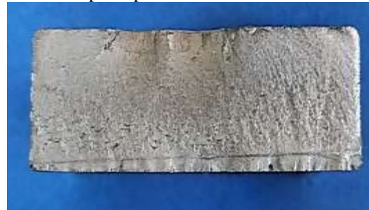
Figura 10 – Superfície de fratura do corpo de prova 1
