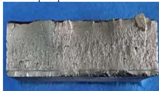
Figura 11 – Superfície de fratura do corpo de prova 2
